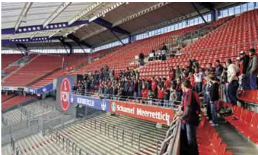
Franken-Stadion Nürnberg: Ermittlung des Schwingungsverhaltens beim „Hüpftest“
